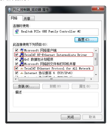
2. 然后回到倍福PLC的上位编程软件TwinCAT 2的"TwinCAT System Managerment"中(或者TwinCAT 3的某目录下)新建一个工程项目,在这个界面,进行相关网络端口的配置及操作:安装并使能网卡,如下图,点击"Options"下的"Show Real Time Ethernet Compatible Devices"
