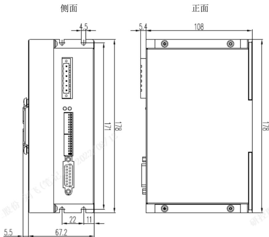
安装尺寸图 (单位: mm)
